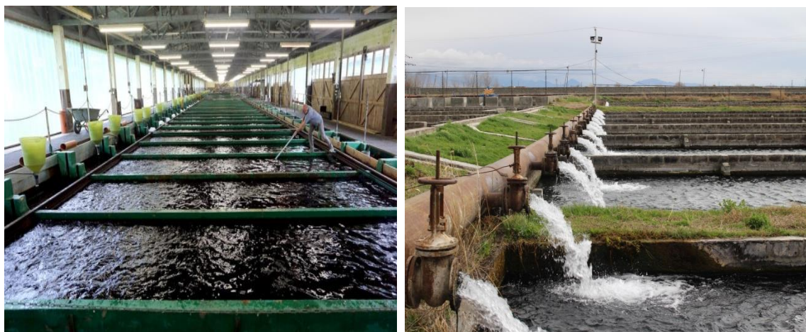
Figure 1 : disposition des bassins en parallèle ( https://www.shutterstock.com/fr )
