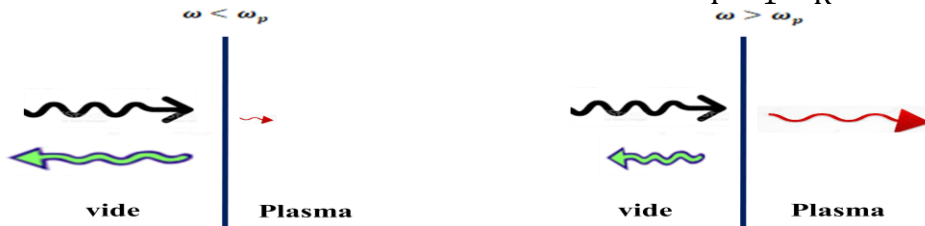
Figure III.8. Réflexion d'une onde électromagnétique par un gaz ionisé
