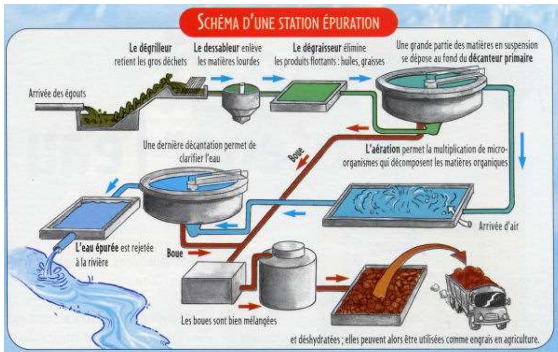
Figure 18 : Fonctionnement d'une station d'épuration
