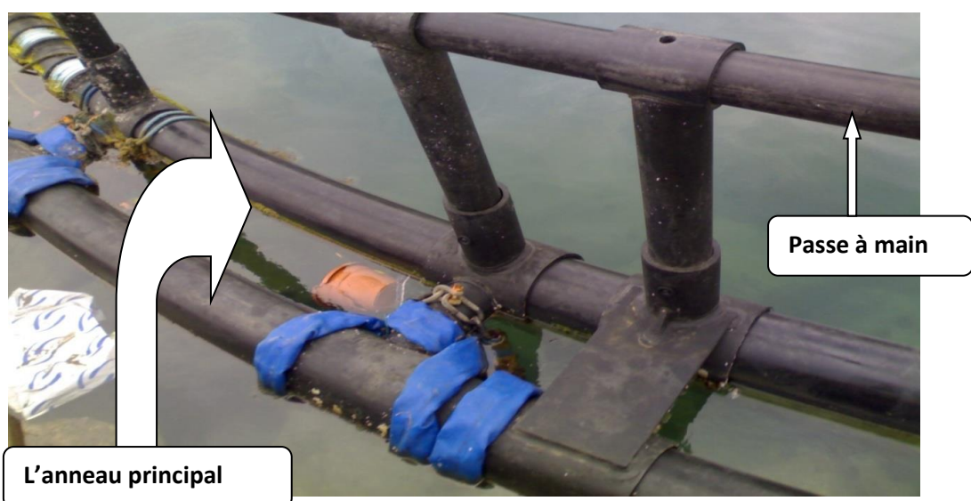
Figure 12. Anneaux principale et secondaire d'une cage submersible.
