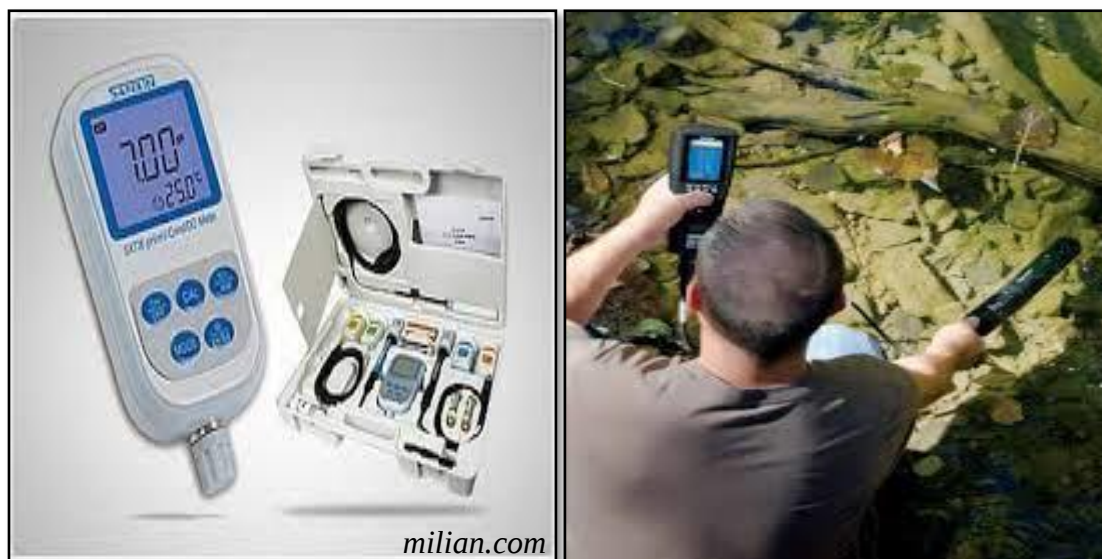
Fig. 14 : Analyse physico-chimique de l'eau, (a) : multi-paramètre de terrain, (b) : mesure in situ des paramètres physico-chimique.
