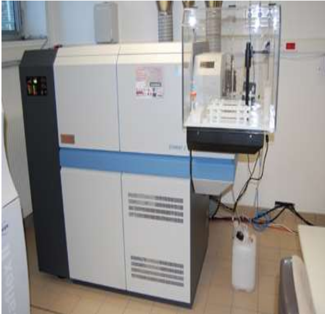
Figure 10 : Spectromètre par torche à plasma à couplage inductif (ICP) (Google, 2021).
