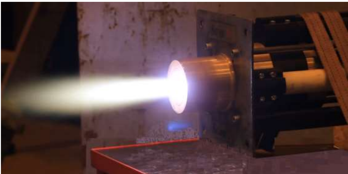
Figure 8 : Torche plasma pour spectrophotomètre d'absorption atomique (SAA) (Google, 2021).
